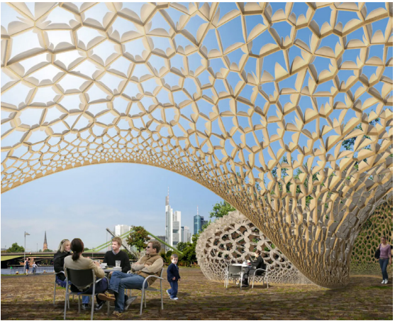
fig.13 – Vue du FAZ Pavilion Frankfurt, pavillon de recherche conçu par Achim Menges, mettant en œuvre une structure générative fabriquée par procédés robotisés. Source : Achim Menges, consulté le 12 janvier 2026.
