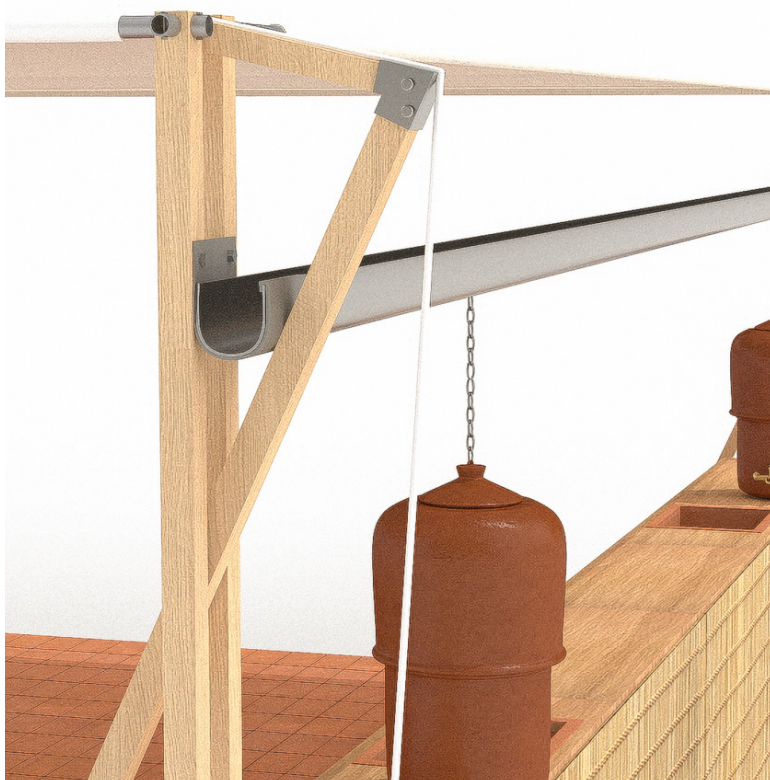
02-Assemblage de tasseaux, gouttière et chaîne de pluie.
