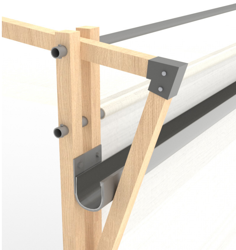
05-Assemblage de gouttière en inox sur tasseaux.
