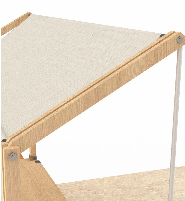
05-Assemblage de tasseaux, tubes métallique et toile tendue
