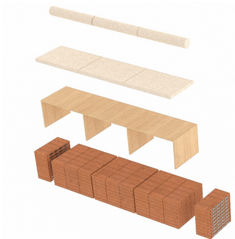
01-Assemblage de banquette en briques et planches de bois, avec tiges filetées.
